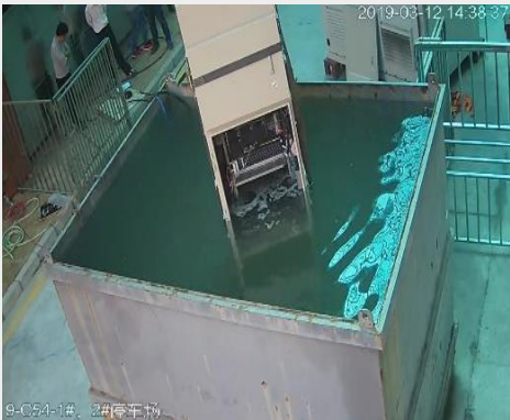
②测试中： 模拟3.1%海水盐度浸泡24h
